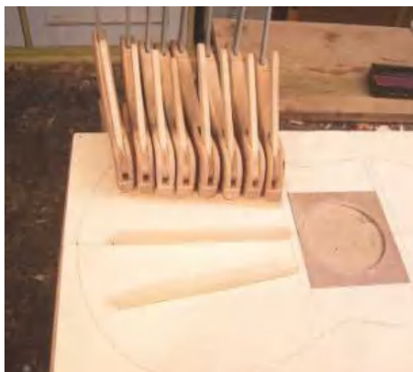
STEP 9. Clamping the fan bracing
